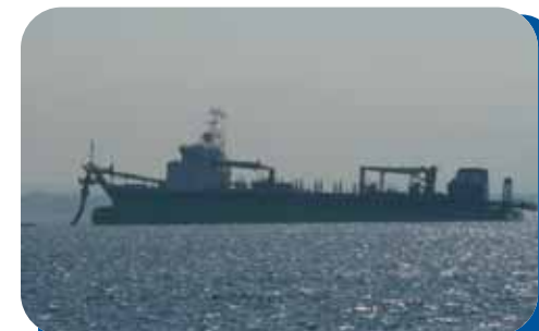
Nave per il prelievo della sabbia
